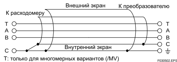
Рисунок 3.4 Устройство сигнального кабеля разнесенного типа
