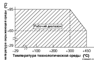
Рисунок 9.4.1 Диапазон температуры технологической среды для высокотемпературного варианта
